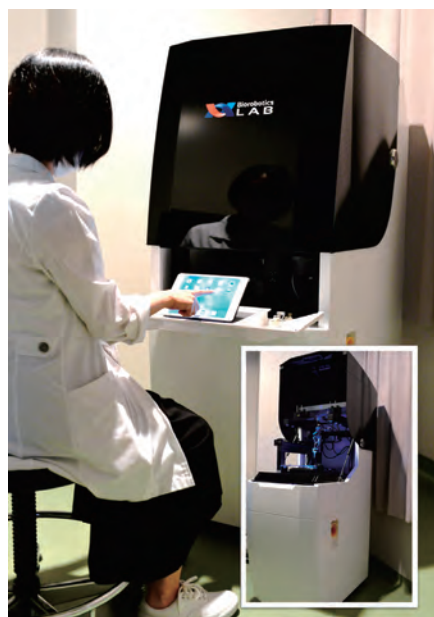
図1 希少細胞ソーター:希少細胞を生きたまま単一細胞レベルで分取するシステム
