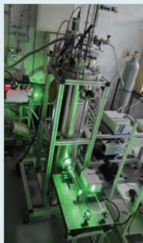
(左図)極低温状態をデュアー内につくり出す。(右図)固体水素を用いた量子乱流の可視化
