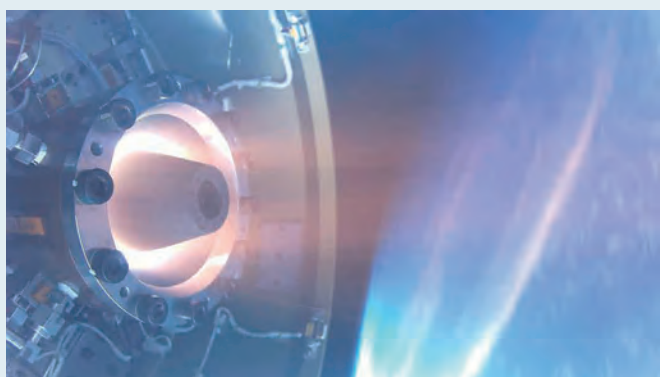
図1 回転デトネーションエンジン(RDE)の宇宙空間での世界初の作動の瞬間。画面左の楕円状の発光部分が二重円筒型の回転デトネーションエンジンの燃焼器部分。推力は約500N。画面右は宇宙空間から撮影された地球。本画像データは展開型エアロシェルを有する再突入力プセルRATSにて洋上回収しました。【Credit: Nagoya University, JAXA】
