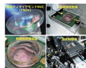
図3 蛍光ナノダイヤモンドNVC (FNDs) による幹細胞温度計測システムの概要図と写真
