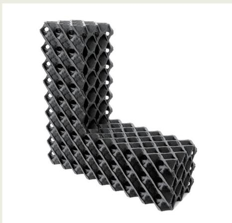
図1 短繊維CFRPラティス構造の積層造形の例
