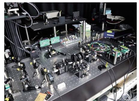
図3 広帯域ファイバレーザー光源を用いたイメージングシステムの実験系。まとめるとコンパクトになり、企業と協力して製品化を進めています。
