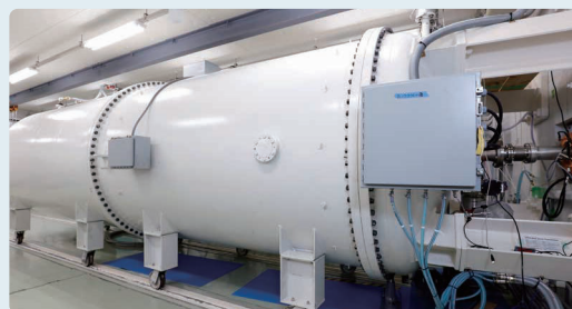
中性子発生に用いるダイナミトロン加速器。15mAという大電流陽子ビームを発生させることができる。
