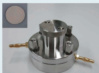
図1 新規固体電解質とイオン伝導度測定セル
