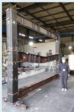
図1 火災実験後の鉄骨試験体の様子。真ん中の梁が大きく変形している。写真内人物は研究室の博士後期課程の学生(実験を主担当)。
