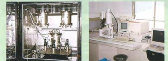
コンクリート、土、岩石など多孔質不均質材料内の水分拡散、各種溶液の拡散および化学物理吸着現象を再現し、拡散の物理モデル、吸着脱着の化学物理モデルを構築する。主装置の中に更に拡散セルが3個配置されていて、全く同一な拡散現象を3現象再現し、その際の内部状態および外部変形を高性能電子顕微鏡、X線マイクロアナライザー、高精度レーザ変位計などを用いて測定する。
