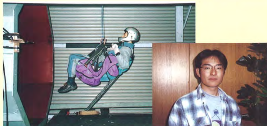
ライダーの空力抵抗の風洞実験中の川口竜太君
