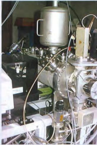
反応性ガスを電子ビームで分解してから1種類のイオンのみを抽出・加速して照射するラジカルイオン源と、複合照射用の中性ラジカル源を装備している。さらに、これらの制御されたビームがシリコン等の基板上で起こす表面反応を in situ で調べるため、四重極質量分析計、FT-IR装置、XPS装置等も備えている。本装置は、プラズマエッチングやCVDの表面反応に関する新しい知見を提供しつつあり、未知の機構解明に威力を発揮すると期待される。 菅井秀部 教授
