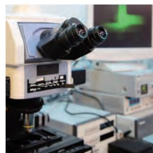
蛍光顕微鏡によるマイクロ空間内の流体挙動の観察の様子
