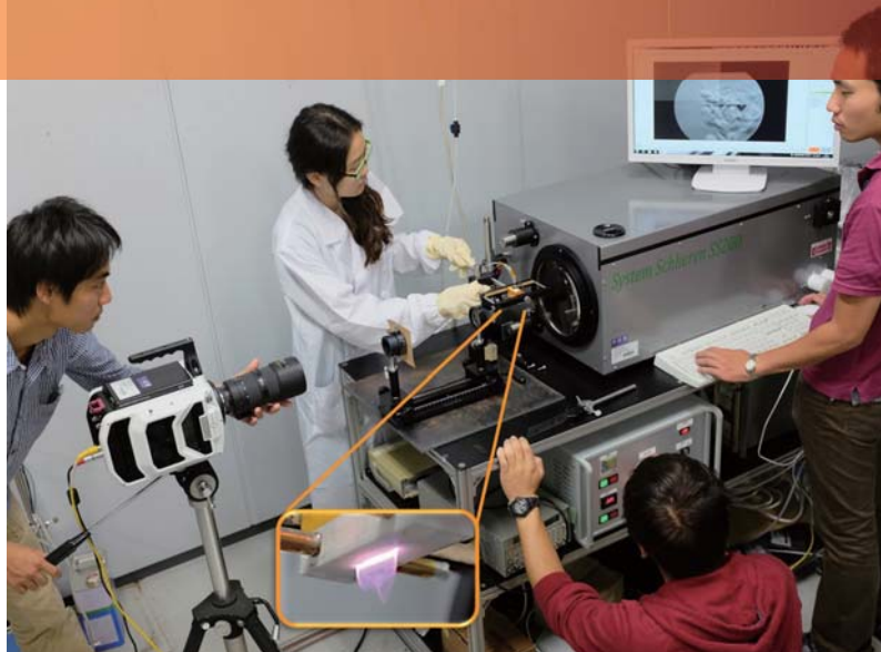
図2 名古屋大学が開発した世界一密度の高い医療用常温常圧プラズマを時空間分解計測する大学院生の実験の様子。本計測装置は、オールジャパンの研究者が自由に使用する共通設備として稼働している。
