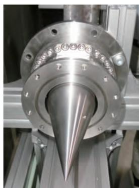
図2 回転デトネーションエンジンの原理図(左)と試験機(右)
