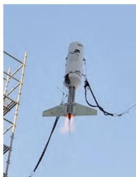
図1 極超音速燃焼波:デトネーションの構造及びデトネーション前後の圧力温度分布(左)とパルスデトネーションロケットの飛行実証機「Todoroki II」(右)
