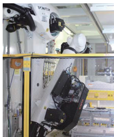
シャシーの一部であるサイドシルなどの部品の製造に使用されるロボット
