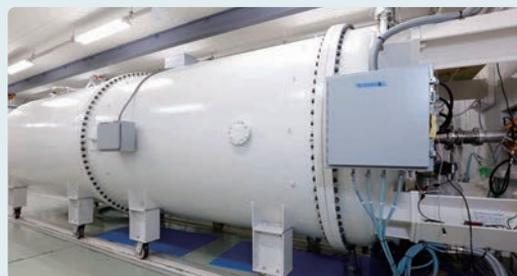
中性子発生に用いるダイナミトロン加速器。15mAという大電流陽子ビームを発生させることができる。
