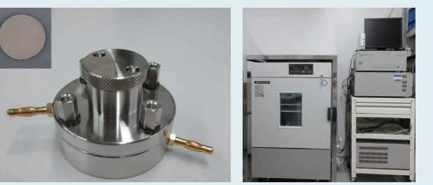
図1 新規固体電解質とイオン伝導度測定セル
