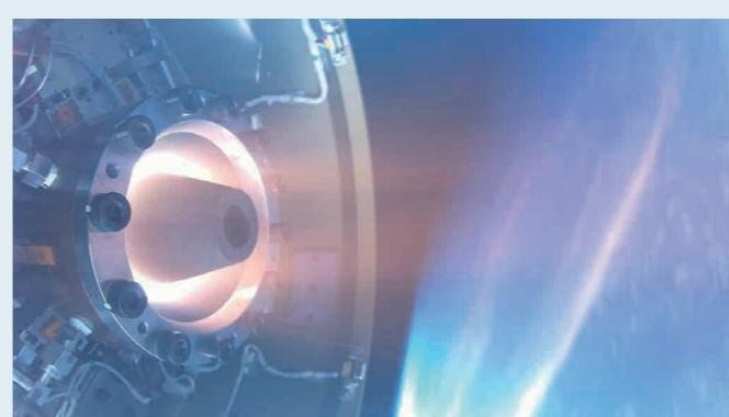
図1 回転デトネーションエンジン(RDE)の宇宙空間での世界初の作動の瞬間。画面左の楕円状の発光部分が二重円筒型の回転デトネーションエンジンの燃焼器部分。推力は約500N。画面右は宇宙空間から撮影された地球。本画像データは展開型エアロジェルを有する再突入カプセルRATSにて洋上回収しました。【Credit: Nagoya University, JAXA】
