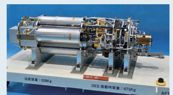
図2 デトネーションエンジンシステム(DES)の写真。【Credit: Nagoya University】
