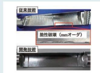
図1 航空機ジェットエンジンのタービンブレード切削時の脆性破壊問題と開発技術による抑制と部品試作(提供:三菱重工航空エンジン)
