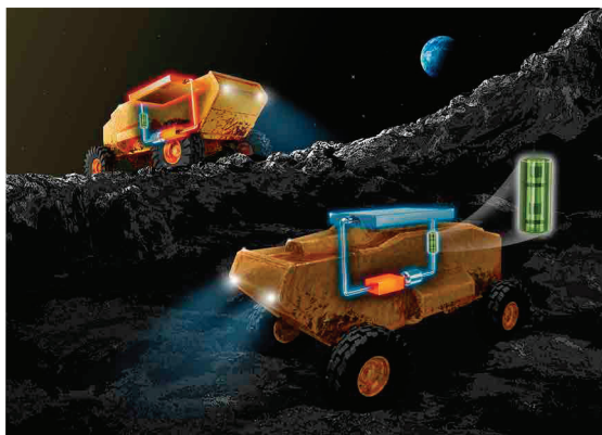
図1 月面ローバに搭載された本熱制御デバイスの昼夜の動作の様子
